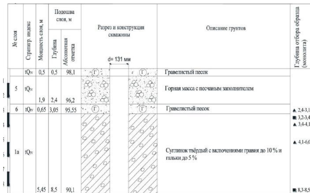
Рисунок 2.3.3 – Геологическое строение оголовка правобережной плотины во II понижении, полученное по результатам бурения скв. №8 в 2016 г.
